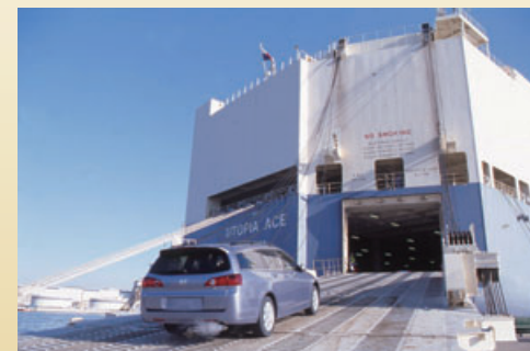
自動車専用船の船尾にあるランプウェイから専門のドライバーが1台1台運転して積み込む
