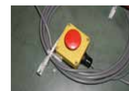
緊急停止 ボタン
