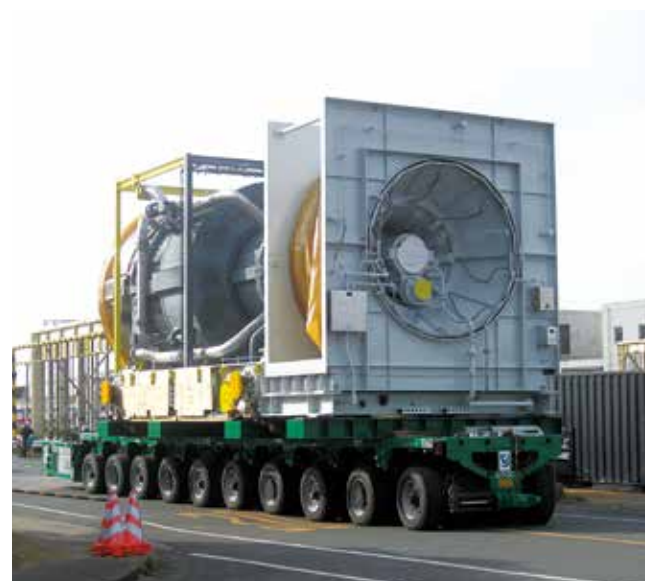
9軸単車編成 GTローター重量約 135ton
