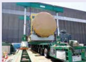
「スーパーリフト」だけでは揚程が足りない場合などは、「スーパーリフト」の下に「スーパーテーブルリフト」を設置して作業を行うことをお勧めいたします。異機種同士ですが、ワンマンコントロールが可能です。「テーブルリフト」+「スーパーテーブルリフト」の一体型揚荷装置を用いて重量物を揚重し、「スーパーキャリア」を用いて輸送するケースを実現させます。当社保有の特殊車輛・機材の能力をフルに発揮させて、迅速かつ安全に作業を行います。
