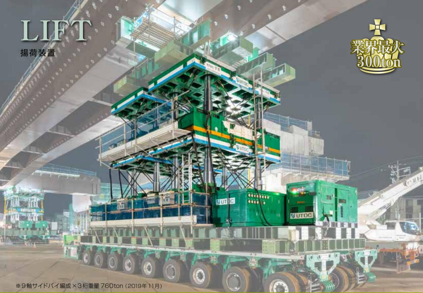
※9軸サイドバイ編成×3桁重量 760ton (2019年11月)
