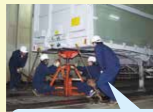
船内ではフェリーシャーシをしっかりと固縛（ラッシング）
