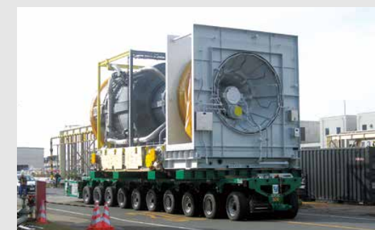
10 軸単車編成 GTローター重量約 135ton
