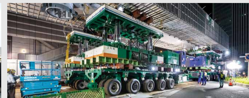
5 軸サイドバイ編成×4 桁重量 77ton
